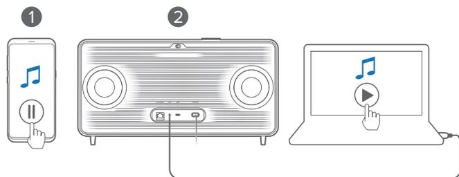
1. Pastikan speaker telah disambungkan dengan benar ke perangkat audio eksternal (Lihat "[5.3 Menyambung ke perangkat audio eksternal](#)").
